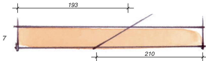
**7.** Dann schrauben Sie die beiden ausgesägten Leisten (7) wie abgebildet an die Dachlatte (6). Verwenden Sie hierzu je eine kurze (11) und eine lange Senkkopfschraube (12).
