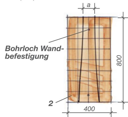
3. Sägen Sie die aufgezeichneten Konturen mit einer Stichsäge aus. Verwenden Sie hierzu ein feines scharfes Sägeblatt. Anschließend runden Sie alle Schnittkanten mit grobem Schleifpapier ab.
