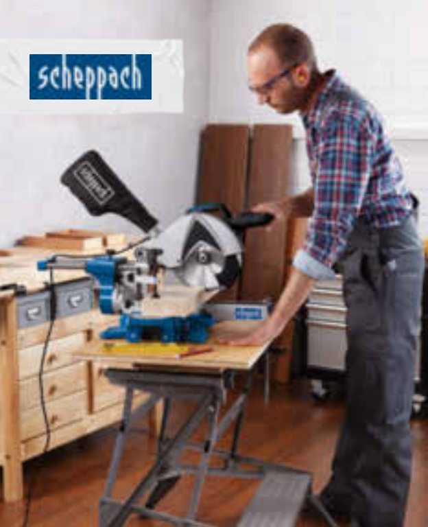
Universal-Kapp-Zugsäge „HM80MP“* 230 - 240 V, 1.700 W, Sägeblatt-Ø 216 mm, Sägeblatt-Drehzahl 3.800/5.000 min -1 , Drehteller-Ø 260 mm, Neigungswinkel 1 x 45°, Gehrungswinkel 47° links bis -47° rechts, 2 Geschwindigkeiten, für Holz, Aluminium, Plastik, Kupfer und Metall, Art.-Nr. 1500750
