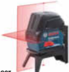
Kombilaser „GCL 2-15 Professional“ Arbeitsbereich 15 m, Nivelliergenauigkeit ± 0,3 mm/m, Selbstnivellierbereich ± 4°, Art.-Nr. 1500827 109.99
