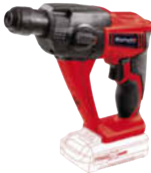
Akku-Bohrhammer „TE-HD 18 Li-i“ – Solo Metall-Getriebe, Universal-SDS-plus-Aufnahme, Schlagzahl 0 - 5.700 min -1 , Leerlaufdrehzahl 0 - 1.100 min -1 , max. Drehmoment hart 14 Nm, Schlagstärke 1,2 J, ohne Akku/Ladegerät, Art.-Nr. 1500702 72.99
