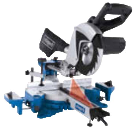
Universal-Kapp-Zugsäge „HM100MP“* 230 - 240 V, 2.150 W, Sägeblatt-Ø 255 mm, Sägeblatt-Drehzahl 3.200/4.500 min -1 , Drehteller-Ø 260 mm, Neigungswinkel 1 x 45°, Gehrungswinkel 47° links bis -47° rechts, 2 Geschwindigkeiten, für Holz, Aluminium, Plastik, Kupfer und Metall, Art.-Nr. 1500751
