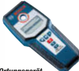
Ortungsgerät „GMS 120 Professional“ Erfassungstiefe Stahl max. 120 mm, Erfassungstiefe Kupfer max. 80 mm, max. Ortungstiefe 120 mm, Art.-Nr. 1500824 77.99
