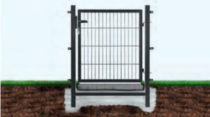
Achtung, hohe Pflastersteine unter dem Toreingang! Bei der Planung des Metallzauns die zusätzliche Höhe zu verlegender Pflastersteine unter dem Toreingang berücksichtigen, die über der einbetonierten Querschwelle und unter dem frei schwingenden Tor verlegt werden sollen.
