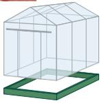
Das kastenförmige Bodenprofil kann direkt mit einem Streifenfundament verbunden werden.
