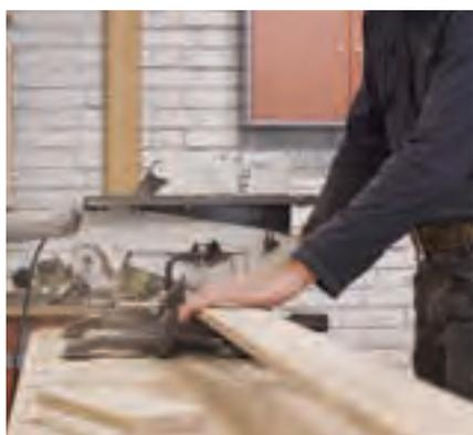
Alle Bauteile für den Rahmen und die einzelnen Lamellen mit der Kappsäge zuschneiden und die Schnittkanten mit Schleifpapier glätten. Gegebenenfalls auch die Oberfläche nach Belieben bearbeiten.
