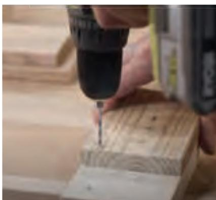
Die Bohrlöcher am Rahmen zur Befestigung der Lamellen in regelmäßigen Abständen einzeichnen, ebenso die Bohrlöcher in den Lamellen, dabei auf die Zentrierung achten. Damit die Unterlegscheiben und Senkschrauben später unsichtbar bleiben, die Bohrlöcher auf der Außenseite des Rahmens versenken.
