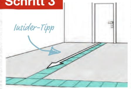
Bestimmte Bezugspunkte im Raum helfen dir bei der Ausrichtung der Fliesen, z. B. die Tür. Ecken haben selten exakt 90 Grad und es besteht die Gefahr, dass die Ausrichtung schräg verläuft. Nimmst du die Tür als Bezugspunkt, gehst du sicher, dass die Fliesen in Eintritsrichtung gerade sind.
