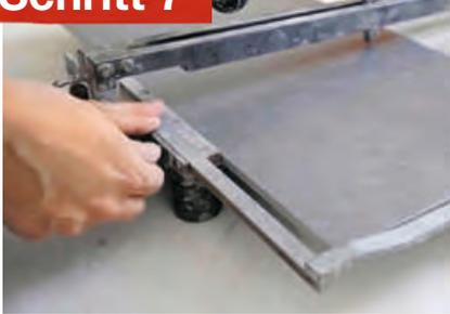
Für das Zuschneiden von Fliesen benötigst du ein Fliesenschneidegerät. Damit ritzt du die Fliesen auf der Oberseite an und brichst sie über der Kante ab. Wichtig: Da zwischen allen Fliesen Fugen liegen, musst du beim Abmessen des Wandbereichs noch die Fugenbreite und den Abstand zur Wand (dieser wird später mit Silikon gefüllt) vom ermittelten Maß abziehen! Für runde Aussparungen verwendest du einen Winkelschleifer und eine Fliesenkniefzange.
