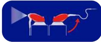
„Flexible®“ – individuell biegbares Sprührohr aus Metall für punktgenaues Sprühen an schwer erreichbaren Stellen
