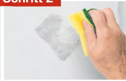
**Saugfähigkeit** Durch das Andrücken eines wasserdurchtränkten Schwammes an die Wand kannst du mühelos testen, wie es um die Saugfähigkeit des Untergrunds bestellt ist. Wenn du danach einen sichtbaren Fleck an der Wand entdeckst, deutet das auf einen stark saugenden Untergrund hin. Ähnlich verhält es sich bei einer dunklen Verfärbung. Eine entsprechende Grundierung kann diese starke Saugfähigkeit sehr gut minimieren.
