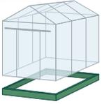
Das kastenförmige Bodenprofil kann direkt mit einem Streifenfundament verbunden werden.
