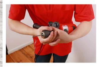
Du steckst den Bohrer in das Schnell-Spann-Bohrfutter der Bohrmaschine. Dann drehst du ihn fest.
