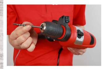
Du nimmst aber zuerst einen kleineren Bohrer. Denn die Wände in einem Altbau sind oft löchrig. Dann kann das Bohrloch ausbrechen. Das heißt: Eine größere Fläche vom Putz bricht aus der Wand. Das willst du vermeiden. Je kleiner der Bohrer, desto geringer die Gefahr, dass das Loch zu groß wird.
