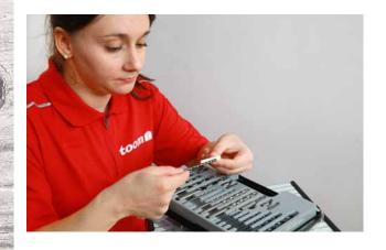
Die Größe vom Bohrer muss zum Durchmesser vom Dübel passen. Oft steht die Größe auf den Dübeln. Zum Beispiel: Ist es ein 6er Dübel? Dann brauchst du auch einen 6er Bohrer. Das bedeutet: Er hat einen Durchmesser von 6 Millimetern.
