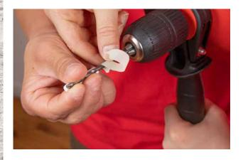
Jetzt siehst du, wie tief du das Loch bohren musst. Du markierst dir die Stelle am Bohrer. Dafür nimmst du ein kleines Stück Klebe-Band.
