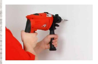
Du setzt den Bohrer an. Er muss genau senkrecht zur Wand sein. Sonst bohrst du schief.
