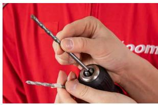
Wenn das Bohrloch noch zu klein ist, tauschst du den kleinen Bohrer gegen einen etwas größeren aus. Damit wiederholst du das Bohren.
