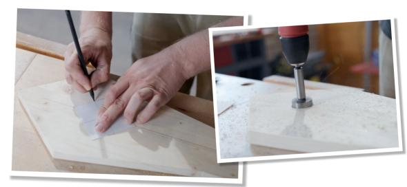
8. Bohre mit dem Forstner-Bohrer 5 mm tief in die markierten Stellen
