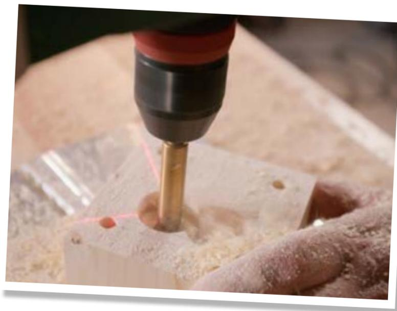
**12.** *Seitlich den Kabelauslass bohren*
