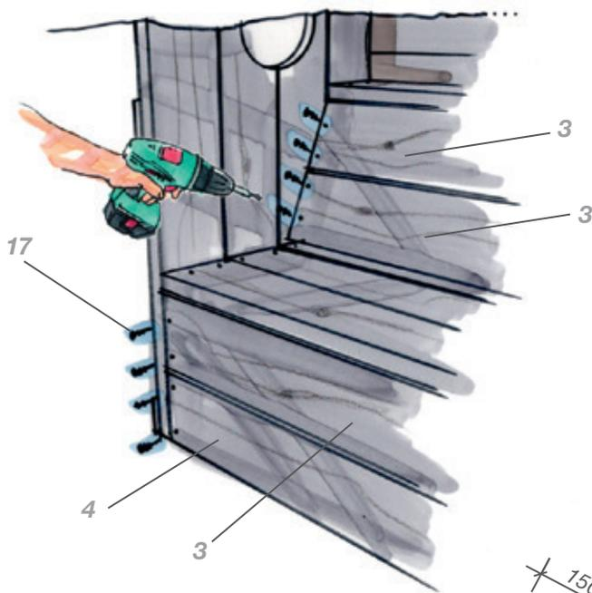
**10.** Als Nächstes befestigen Sie die restlichen Bankbretter (3 und 4). Entnehmen Sie die Position und Ausrichtung der nebenstehenden Zeichnung. Lassen Sie auch hier zwischen den einzelnen Bankbrettern einen kleinen Abstand, damit das Holz arbeiten kann.
