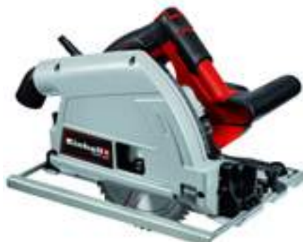
Tauchsäge „TE-PS 165“ Leerlaufdrehzahl 5.200 min -1 , Sägeblatt-Ø 165 mm, Schnitttiefe 56 mm, Gewicht 4,75 kg, Staubsaugadapter, werkzeuglose Einstellung (Schnitttiefe/Neigungswinkel), hochwertiges Hartmetall-Sägeblatt für saubere Schnitte, Sägeblatтарыretierung für leichten Sägeblattwechsel, Parallelanschlag für geradlinige Arbeitsergebnisse, Art.-Nr. 1501343 99.99
