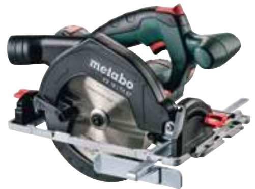
Akku-Handkreissäge „KS 18 LTX 57“* Akkuspannung 18V, Schwenkbereich 0° / +50°, Schnitttiefe 0 - 57 mm, Sägeblatt-Ø x Bohrung 165 x 20 mm, Leerlaufdrehzahl 4.600 min -1 , max. Schnittgeschwindigkeit 40 m/s, Art.-Nr. 1490277
