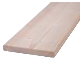
Glattkantbrett Fichte / Tanne technisch getrocknet, 4-seitig gehobelt, Kanten gefast, 18 x 100 x 2.000 mm , Art.-Nr. 7200120 18 x 120 x 2.000 mm , Art.-Nr. 7200122 18 x 140 x 2.000 mm , Art.-Nr. 7200124
