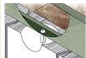
Verdübelung des Stahlblechfundaments
