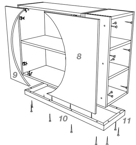
**9** Bohren Sie nun den Sockelrahmen (10 und 11) vor und schrauben ihn mit 4x60er-Schrauben so an, dass dieser mit der Hinterkante bündig abschließt und gleichmäßig seitlich einspringt.
