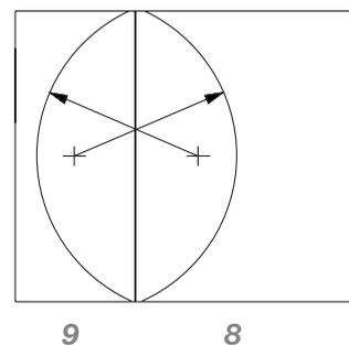
**3** Sägen Sie nun die Bögen mit einer Stichsäge aus. Je feiner und schärfer das Sägeblatt und je genauer Sie arbeiten, umso weniger brauchen Sie später zu schleifen.
