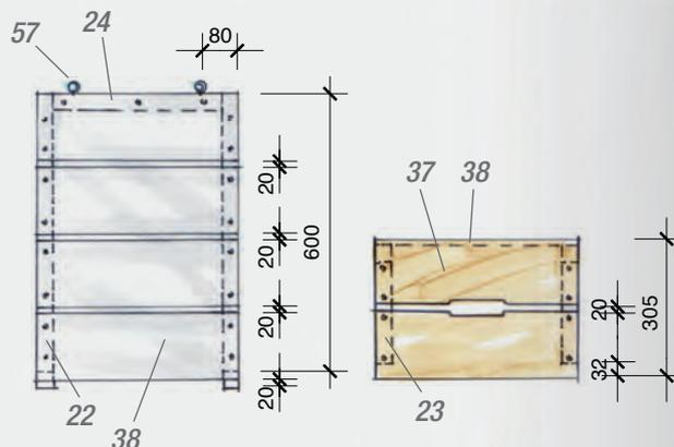
**27** Stellen Sie die Hocker vor die Bank und übertragen Sie die Position der Ösen (57) auf die vordere Quertraverse (6). Drehen Sie an dieser Stelle die Schrankhaken (58) so tief ein, dass sich die Ösen (57) gerade so über die Schrankhaken (58) stülpen lassen. Legen Sie nun die Sitzfläche (35 und 36) auf den Rahmen (6 und 7) und stellen Sie die Rückenlehne (31 und 32) auf das Querbrett (33).
