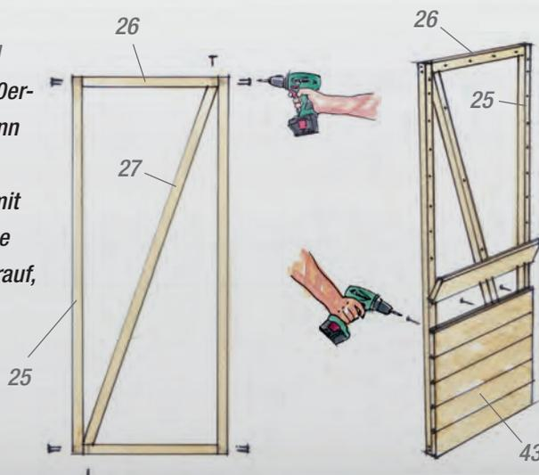
**29** Schrauben Sie dann mit 4 x 45er-Schrauben die Türbretter (43) auf, so dass diese genau seitlich bündig mit dem Rahmen (25 und 26) abschließen. Beachten Sie, dass die beiden Rahmen spiegelverkehrt sein müssen. Das letzte Brett sägen Sie passend ab.
