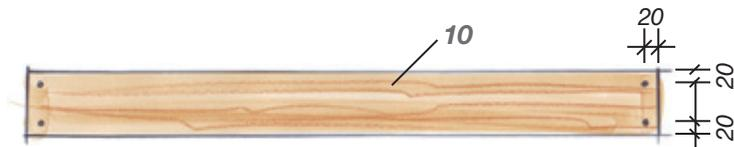
**9.** Als nächstes runden Sie alle Holzteile (1 bis 12) mit grobem Schleifpapier, einer Raspel oder dem Exzentrerschleifer ab und schleifen die Flächen mit dem Exzentrerschleifer einigermaßen glatt. Tragen Sie dann je nach Wunsch eine Lasur oder einen Lack auf. Nach dem Trocknen schleifen Sie alles noch einmal mit feinem Schleifpapier glatt und tragen die Lasur bzw. den Lack ein zweites Mal auf.
