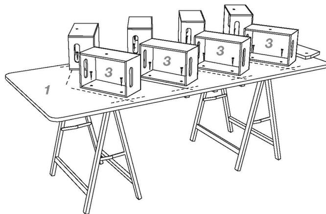
**9** Stellen Sie das Regal an die endgültige Position. Richten Sie es nun mit einer Wasserwaage aus und zeichnen Sie die Bohrlöcher – durch die Rückseite der Kästen (3) – an. Bohren Sie die Löcher in die Wand und schrauben Sie dann das Regal mit Dübeln und Schrauben an die Wand – fertig!
