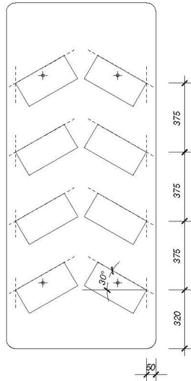
**7** Drehen Sie danach die Platte (1) um. Achtung: Legen Sie vorher Decken oder auch Pappe auf die Böcke, damit der Lack nicht verkratzt! Nun können Sie die Positionen der Allzweckkisten (3) in einem Winkel von 30° anzeichnen (siehe Abbildung). Hiernach schrauben Sie die Kästen (3) mit 3,5x25er-Schrauben fest. Für die Wandbefestigung: Bohren Sie in die später zur Wand zeigende Seite der oberen und unteren beiden Kästen jeweils ein 5-mm-Loch.
