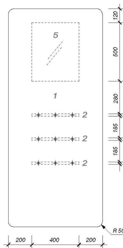
**5** Während der Lack trocknet, können Sie den Stützfuß (4) – wie abgebildet – an den Seiten schräg absägen. Dann runden Sie alle Kanten des Stützfußes und der Ablageböden (2) mit 180er-Schleifpapier ab und schleifen alles glatt. Nun können Sie diese Teile mit Genius PRO Klarlack grundieren. Nach dem Trocknen schleifen Sie diese Teile mit 220er-Schleifpapier, da Sie den Lack ein zweites Mal auftragen sollten. Wenn Sie möchten, lackieren Sie die Allzweckkisten einfach genau so!
