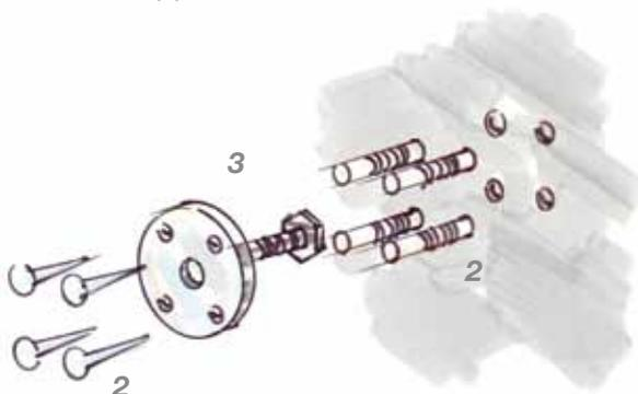
**4** Schrauben Sie das Systemrohr (4) auf die Anschraubplatte (3).
