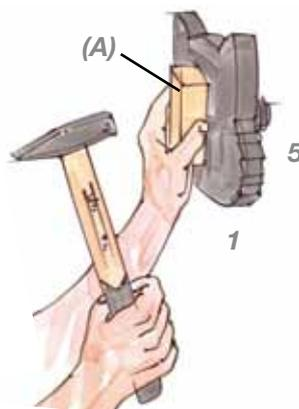
treiben dann den Kopf (1) mit der Gewindehülse (5) in das Systemrohr (4), indem Sie mit dem Hammer auf das Restholz schlagen.
