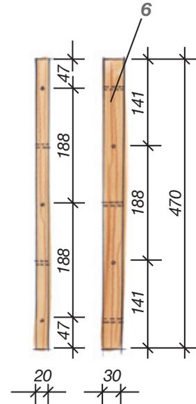
3. Verschrauben Sie die Seitenbretter (1) und die langen und kurzen Holzlatten (6 und 7) zu zwei Seitenelementen. Verwenden Sie hierzu die 3,5x30er-Schrauben (8). Beachten Sie, dass der Abstand der langen Holzlatten (6) zum Rand des Seitenbrettes (1) nicht auf beiden Seiten gleich groß ist.
