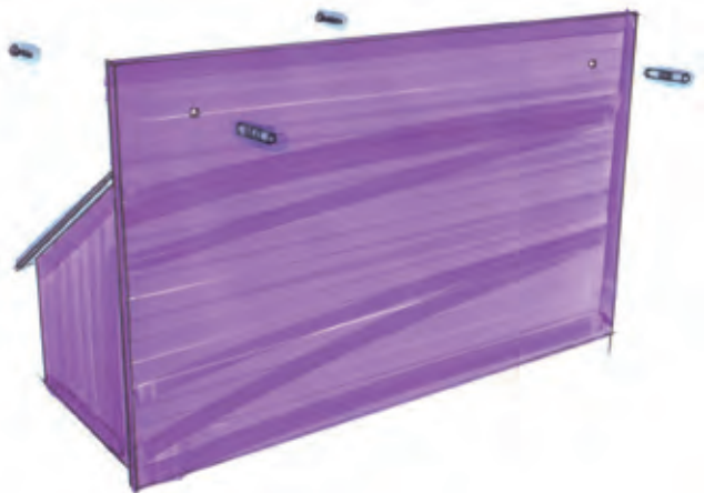
Wandmontage mit Dübeln und Schrauben
