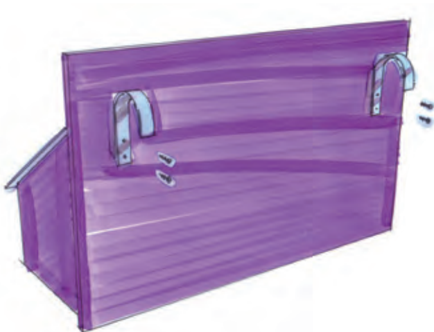
Haken ermöglichen das Aufhängen z. B. am Balkongeländer
